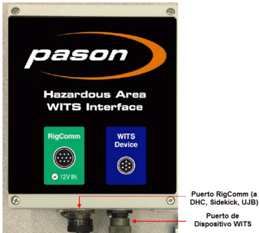
Figura 5: Caja de comunicación COMM087 y sus componentes
